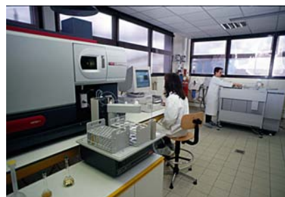
Contrôle qualité avec appareil à fluorescence X robotisé et analyseur torche à plasma
